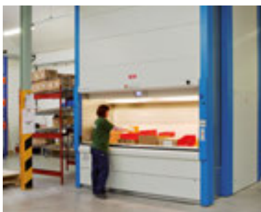
KARDEX. Velkokapacitní automatizovaný skladovací systém.
