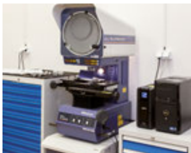
Profilový projektor. Laboratoř oddělení kvality.
