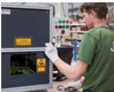
Laser při procesu vypalování loga.
